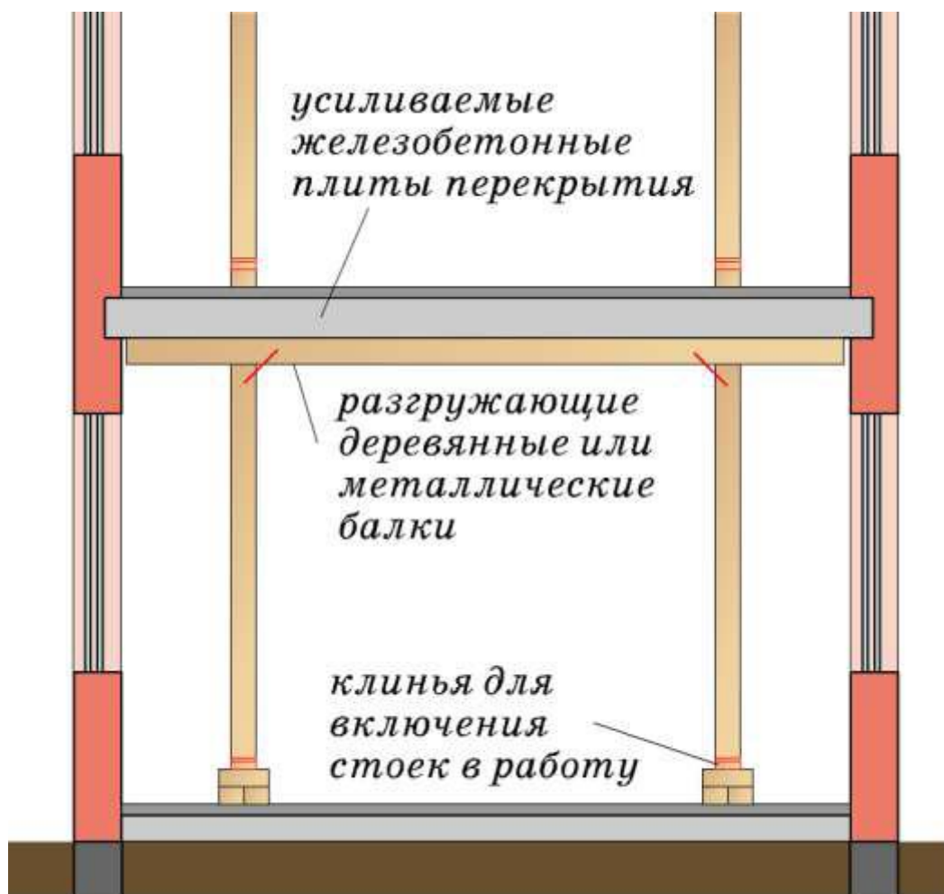
Рисунок 9.46. Подведение разгружающих балок
